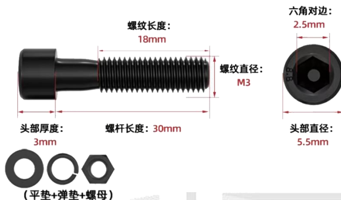
图 8 安装螺栓各部件尺寸
