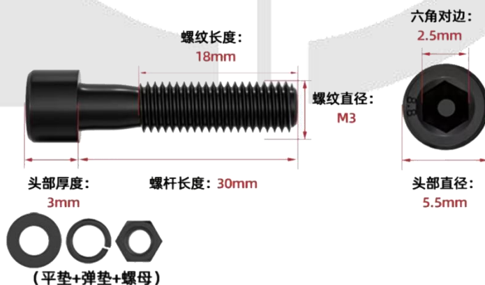
图 8 安装螺栓各部件尺寸
