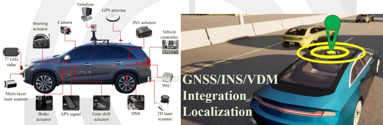
图 3 自动驾驶汽车与组合导航系统
