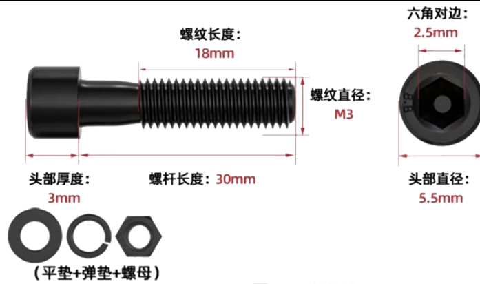
图 7 安装螺栓各部件尺寸
