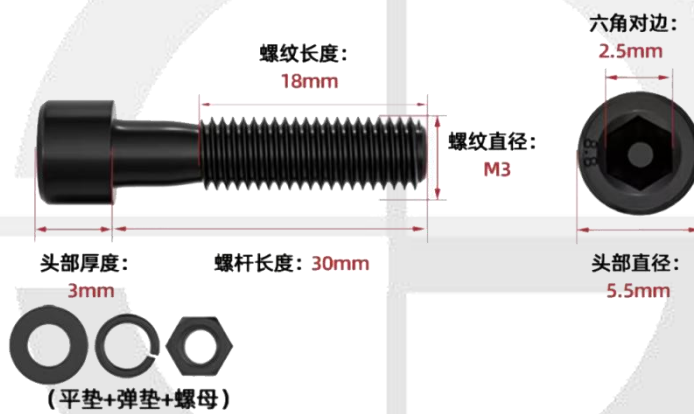
图 7 安装螺栓各部件尺寸
