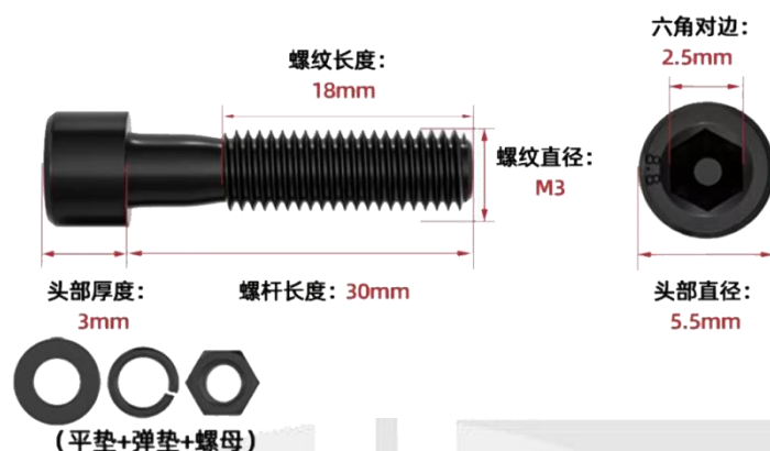
图 7 安装螺栓各部件尺寸
