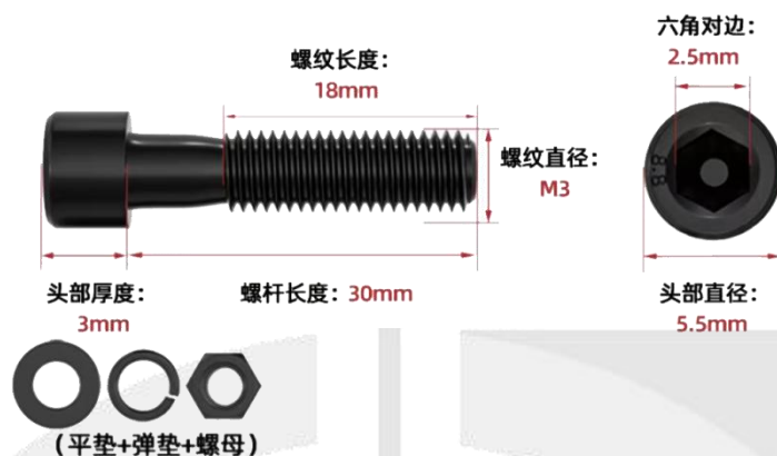
图 7 安装螺栓各部件尺寸
