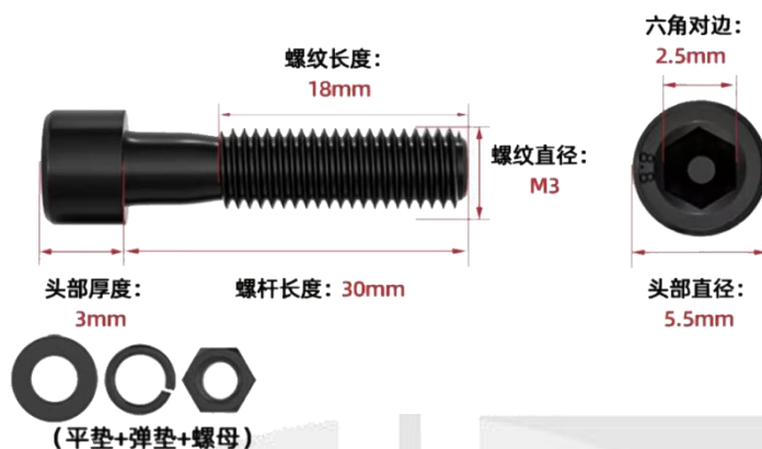
图 7 安装螺栓各部件尺寸
