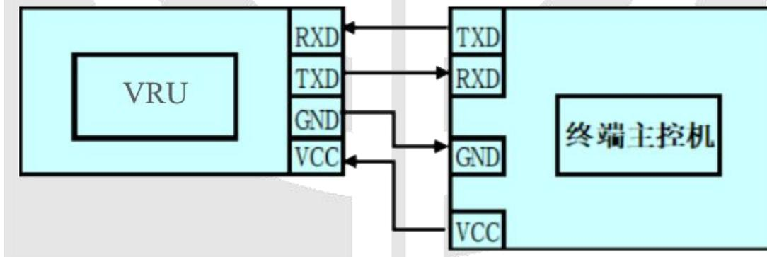
图5 传感器与终端主控机连接示意图
