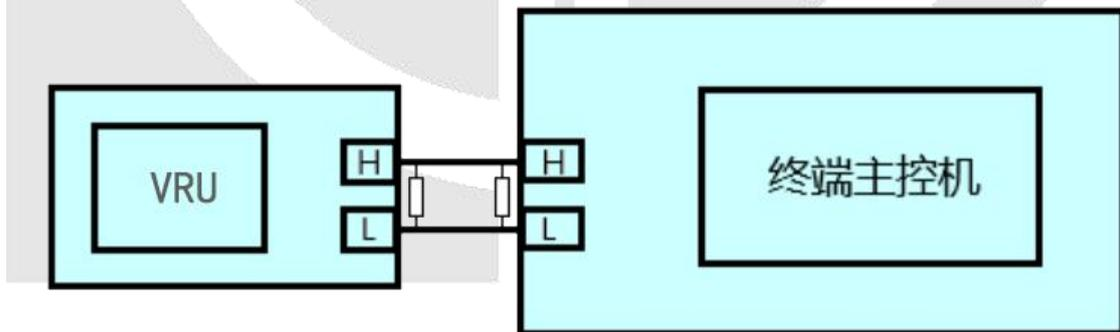
图7 IMU 与终端主控机 CAN 连接示意图
