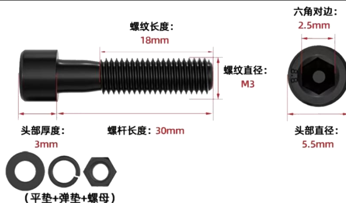
图 7 安装螺栓各部件尺寸
