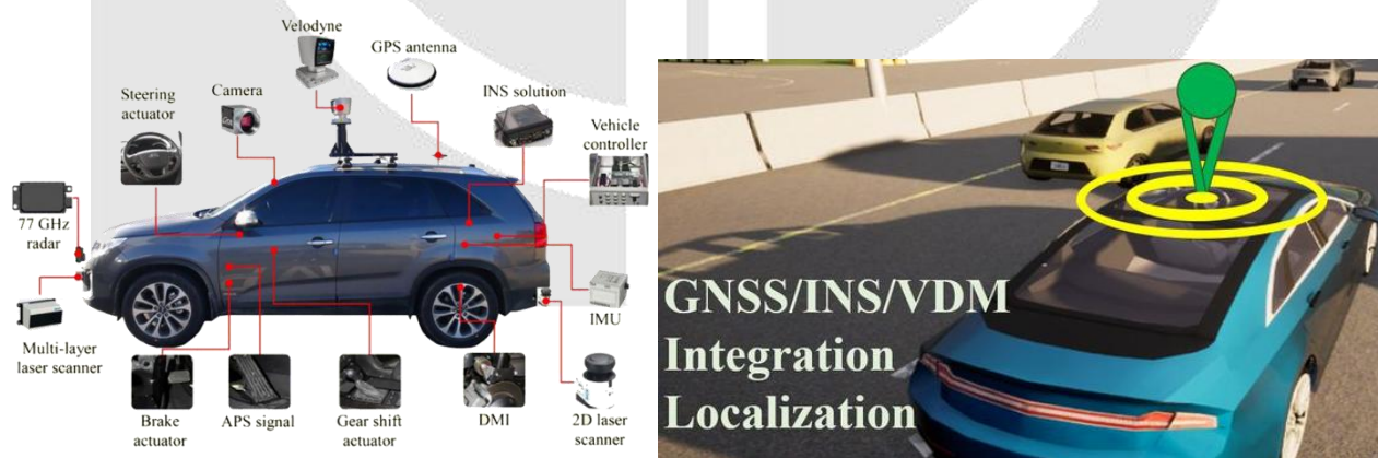
图 1 自动驾驶汽车与组合导航系统
