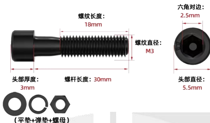
图 7 安装螺栓各部件尺寸
